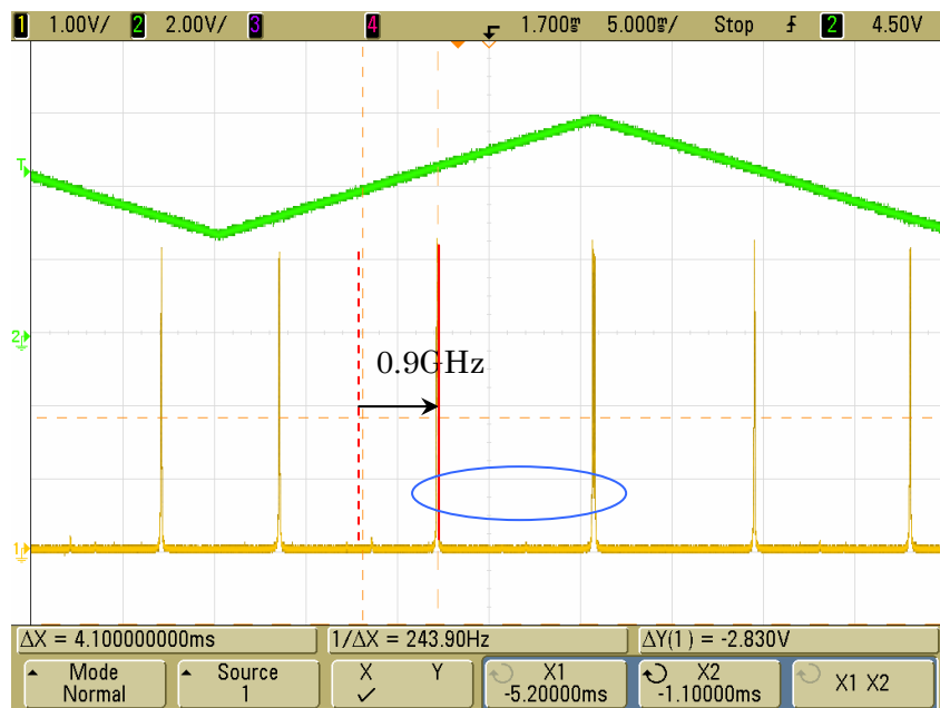
図 4.7 外部共振器型半導体レーザーの波長掃引後の発振状態
