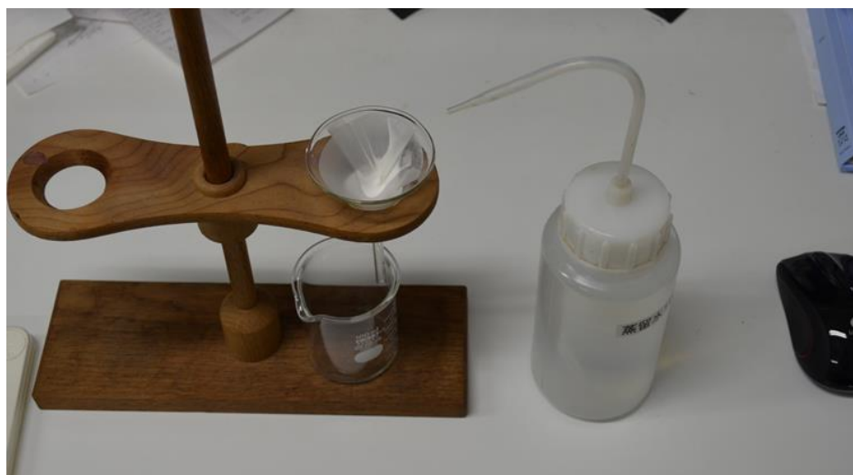
図7 粒子のろ過装置
